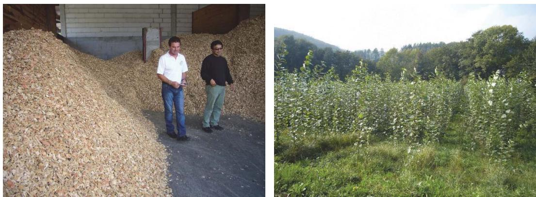
チップ原料は2,500~2,800m<sup>3</sup>/年必要で、林地残材の方が少し高価なため10km先の製材工場の端材のみ使用しています。最近はチップ価格も高騰しているため7年で収穫できる木(ヤナギの一種)の栽培も始めました。ドイツでは世帯の20%が木質暖房、その内1/5は給湯も木質系ボイラーで、古いガスや石油ストーブの買い替えがここ数年急速に増えているようです。理由は石油とガスの高騰、助成金、活発な林業や木材業です。田舎では薪、都会ではペレットが主流のようです。
