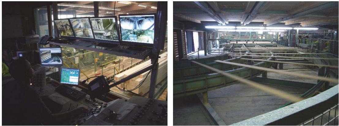
製材ラインは大径木、小中径木の2つのラインにて、注文データが入力されたコンピューター一括管理にて、チッピングキャンター＋丸ノコで高速大量製材され、ユーザー別のボックスに製品が自動分別されます。オペレーター室はおが屑や騒音から分離され、ディスプレイで全ての行程の管理ができるようになっています。
