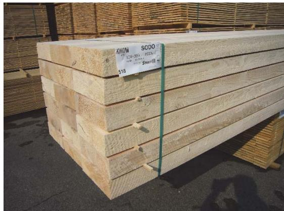
Streit 社では 80 人の従業員にて年間 38 万 m<sup>3</sup> の原木を取扱っています(今期は金融危機の影響で 32m<sup>3</sup> 程度)。原木入荷はトレーラー 1 万 2 千台、製材品出荷はトレーラー 9 千台分です。全て針葉樹で建築用材がメイン。製材歩留まりは 50% でチップはすべてパルプ用、おが粉は MDF 用として各工場から取りに来ます。原木調達は 90% が 150 km 圏内の黒い森から、製材品出荷先は、フランス(48%)、イギリス(16%)、ドイツ(10%)、アイルランド(9%)、その他で、9 割が輸出です。各ユーザーの規格別に製材しています(フランス規格は、屋根野地板 36 mm × 97 mm × 3~6m、柱梁 75 mm × 200、225 mm)。日本へも輸出していたようですが現在は行っていません。北ドイツの方では規模が大きすぎて地域材だけでは賄えないところもあるようです。
