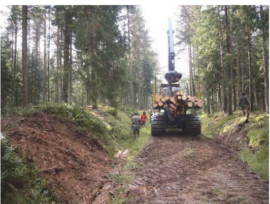
ドイツは路網や林業機械の整備で有名ですが、路網整備は 1960 年代から補助金もかなり投入され (林道は 70~80% 補助)、20m の原木を運ぶトレーラーの林道は 50m/ha、林業機械のための作業道は 60m/ha という密度の道により生産性を高めています。また土をしめ固めた程度の舗装で一般車輌の通行は禁止され、地域の方が散歩にも利用していました。今回の視察では日本
